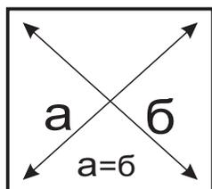
Замерьте диагонали собранного каркаса. Они должны быть равными (+-1,2мм). Только после этого можете закрепить заднюю стенку ЛДВП при помощи гвоздей!
